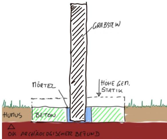
Fundamente für Stecksteine werden als offene Köcherfundamente ausgeführt, wobei der Grabstein mit weichem Mörtelmaterial im Köcher ausbetoniert wird.
