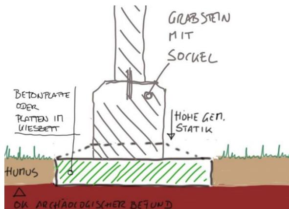
Sockelsteine werden auf Betonplatten oder, wo statisch ausreichend, auf in Kiesbett eingerichtete Waschbetonplatten oder Klinkerziegel trocken versetzt und bei Bedarf verdübelt.
